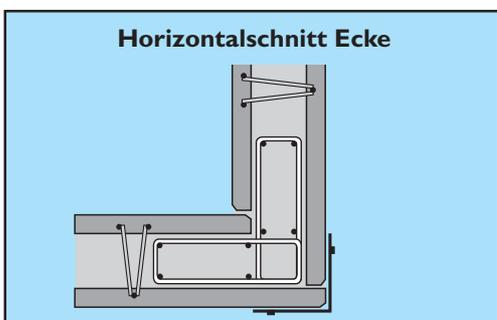
**Wichtig:** Die zulässige Betoniergeschwindigkeit ist im Verlegeplan angegeben. Ohne besondere Maßnahme ist eine Geschwindigkeit von 80 cm pro Stunde möglich (Gitterträgerabstand). Entsprechende Angaben sind im Verlegeplan dargestellt.
