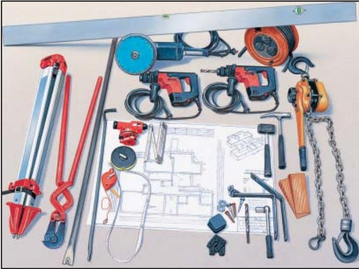
Kettenzug für 5 t, gegebenenfalls Kranhaken, zwei Brechstangen, zwei Nagel-eisen, Hammer, Fäustel, Bandmaß, Meterstab, Schlagschnur, Ölkreide.
